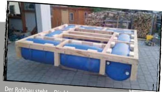
Der Rohbau steht – Die blauen Tonnen sorgen für den nötigen Auftrieb.
